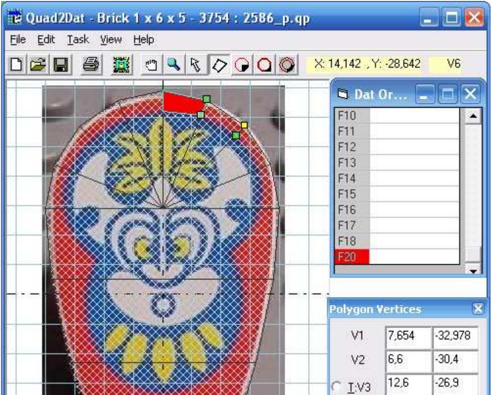
Exemple de duplication : La première lettre "O" a été créée dans Quad2Dat , puis la seconde a été dupliquée avec MLCad avant que le fond blanc entourant les lettres ne soit fait.
